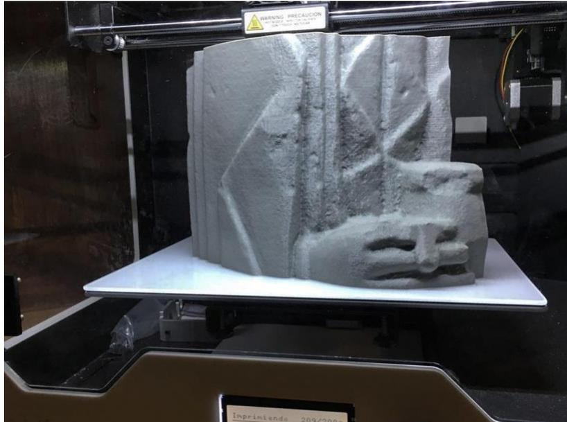
Fig. 2. Proceso de impresión 3D de un fragmento de una de las réplicas expuestas en Vilamuseu.
